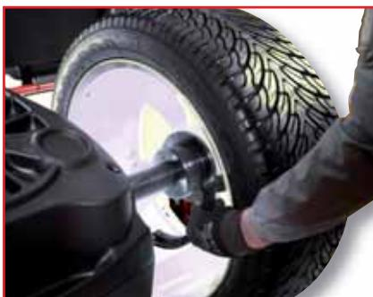
**IT** Nuovo sistema di acquisizione dei dati ruota tramite accelerometro.
